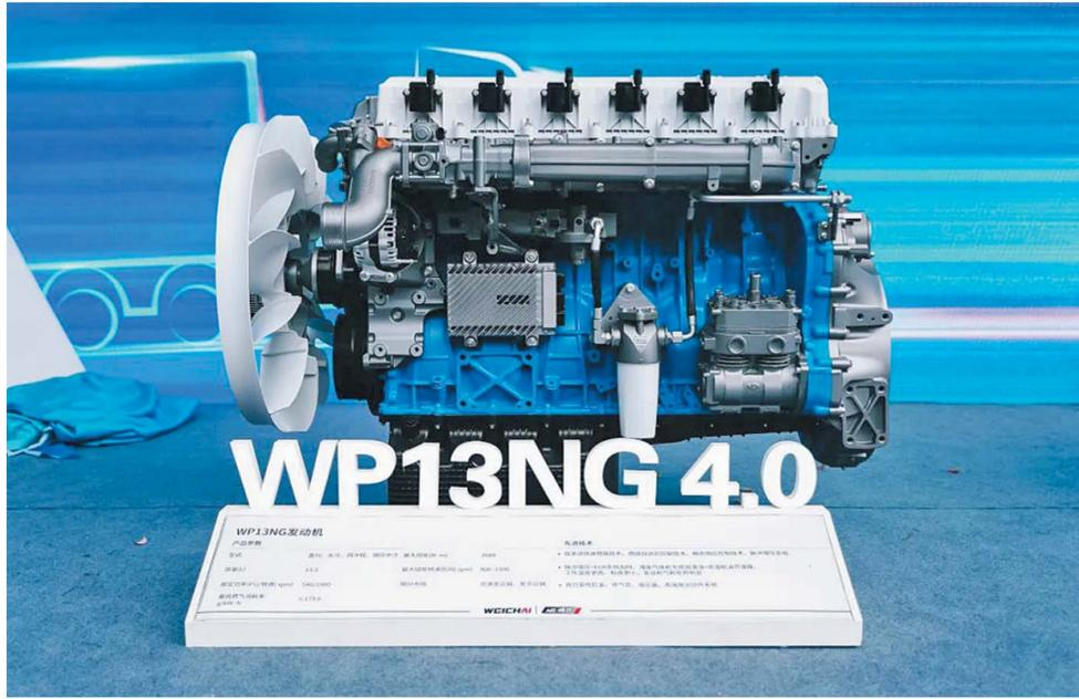
性大幅提升。说到能耗经济性,WP13NG-4.0发动机还有一套“独门组合拳”。首先,通过油门智能控制,结合实际工况,修正油门开度,可实现节油1%;其次,依靠换挡智能控制,结合路况信息,以自适应换挡控制,可实现降低气耗2%;再者,通过扭矩智能控制,实时识别工况,提供最优动力,避免动力浪费,又可节约气耗2%;最后一点是借鉴高热效率平台产品,全面优化加持,最终可实现降低气耗7%。此外,WP13NG-4.0发动机采用了快速燃烧技术、燃烧自适应控制技术、瞬态响应控制技术、高效增
